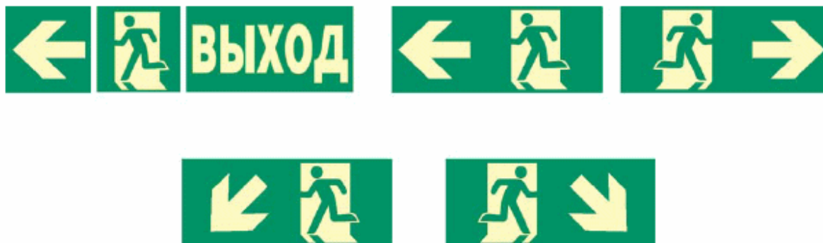
Рисунок 2 - Примеры знаков маршрутов эвакуации или указателей направления, которые допускается использовать вместе с текстом
